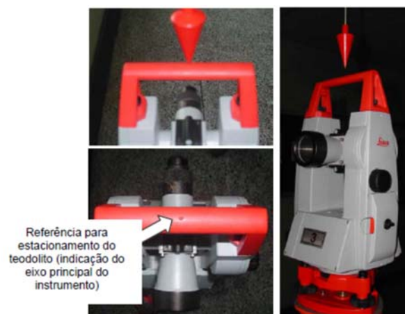
Figura 64: exemplos de centralização dos instrumentos em pontos de teto
