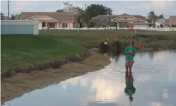
Figura 69: Batimetria feita com estação total(2)
