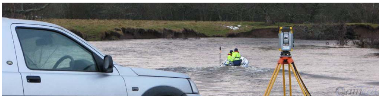
Figura 68: Batimetria apoiada com estação total robótica. Fonte: http://www.caintechltd.com/bathymetric-survey/
