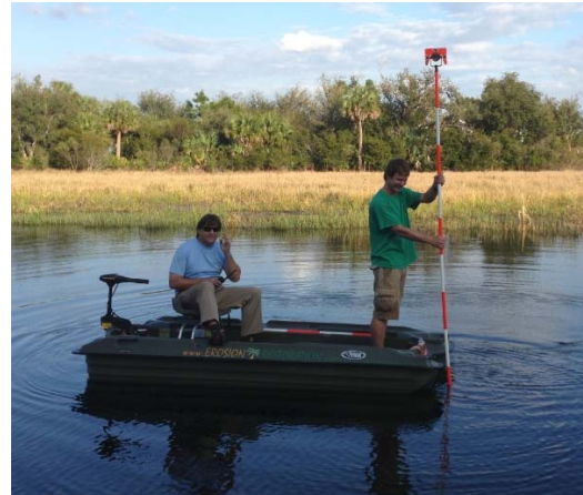
Figura 70 Batimetria feita com estação total e bote.
