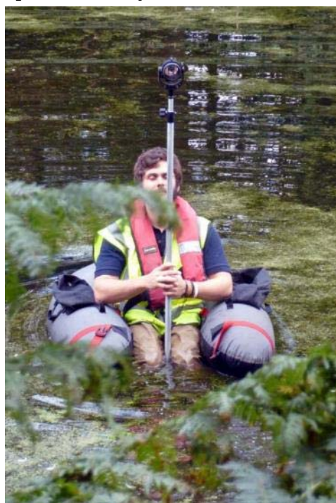
Figura 67: detalhe do porta prisma na batimetria. Fonte: http://www.wansteadpark.org.uk/news/lakes-bathymetric-survey-under-way/
