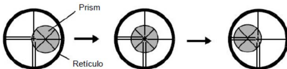
Figura 54: Processo de verificação do eixo ótico horizontal do distanciômetro.
