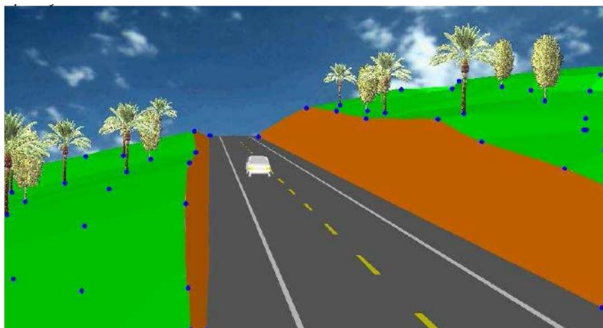
Figura 18: Pontos levantados para a geração do MDT.
