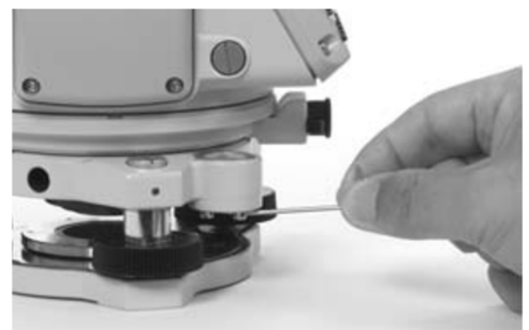
Figura 48: Ex. de ajuste da bolha circular na base nivelante Fonte: Nikon DTM322
