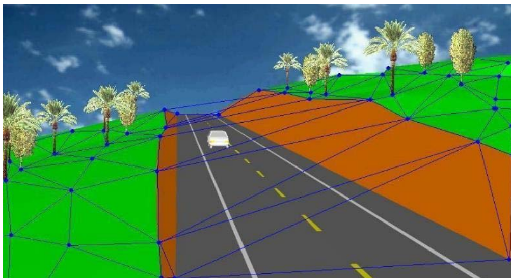
Figura 19: Primeira geração da malha triangular – ressalta-se o erro na triangulação.
