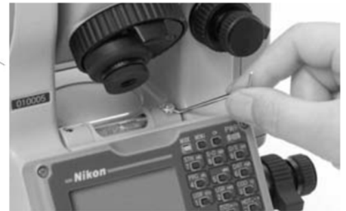
Figura 46: Ex. II do parafuso de ajuste Fonte: Nikon 322
