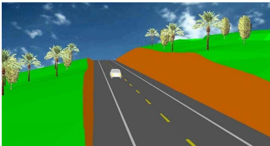
Figura 17: Representação tridimensional de uma área gerada a partir de um MDT.
