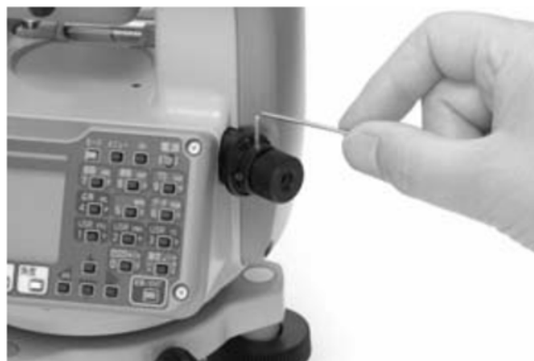
Figura 51: Ajuste do prumo Fonte: Nikon DTM322
