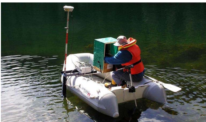
Figura 73: Levantamento Batimétrico com pequeno bote
