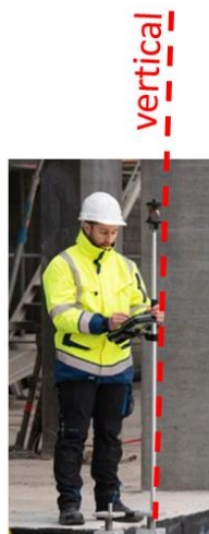
Figura 56: Falta de verticalidade do bastão
