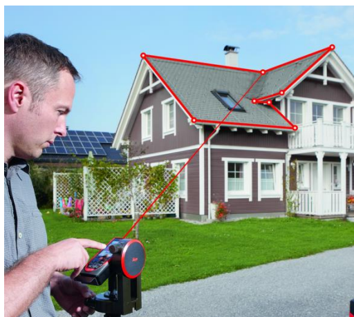
Figura 36: Medição externa com trena a laser com câmera sobre tripé
