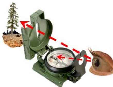
Figura 87: Visada no alvo com bússola de lentes
