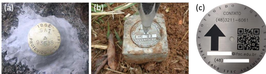
Figura 110: chapa colada (a), concretada no marco (b) ou para parafusar em piso.
