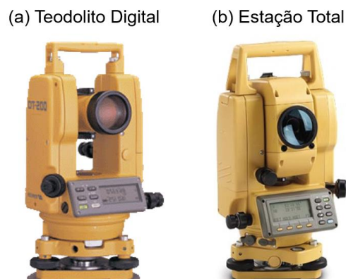
Figura 93: Diferença da luneta do teodolito (a) para a estação total (b) Fonte: www.topcon.com
