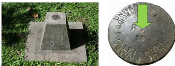
Figura 3: Ponto de apoio (marco)
