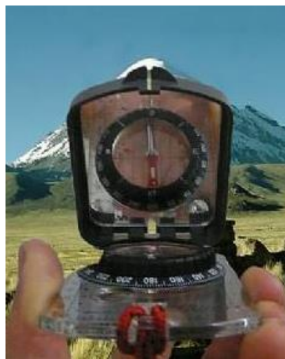
Figura 89: Uso da bússola de orientação com espelho
