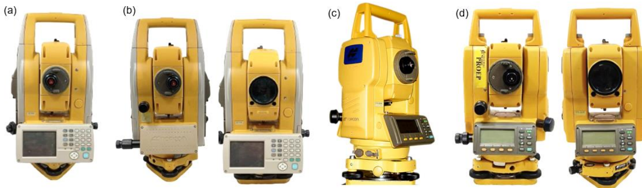
Figura 95: Luneta na posição direta (a e c) e na posição inversa (b e d)
