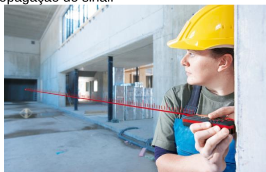
Figura 35: Medição interna com trena a laser Fonte: http://www.leica-geosystems.co.uk
