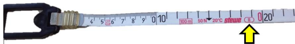
Figura 40: Identificação da classe de exatidão da Trena conforme INMETRO
