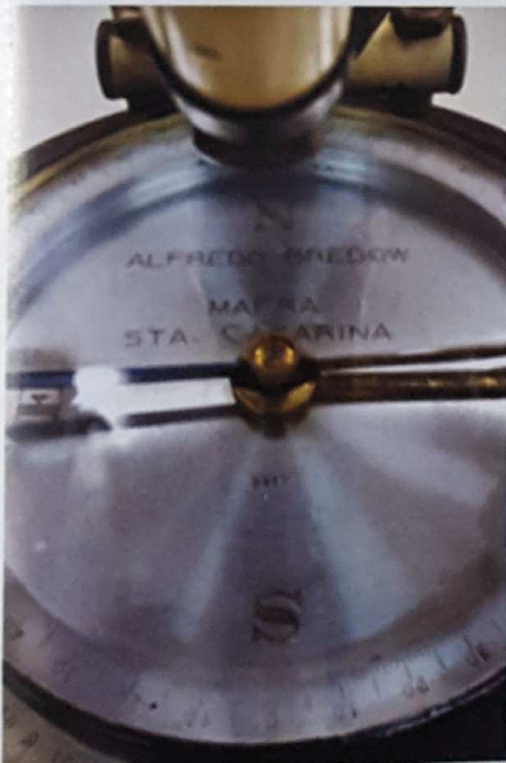
Figura 03 Bússola do teodolito TRB 125
