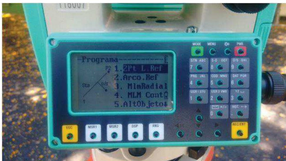
Figura 3 – Display da estação total no menu programa
