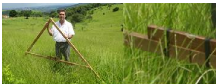
Figura 7: Perpendículo com nível de pedreiro
