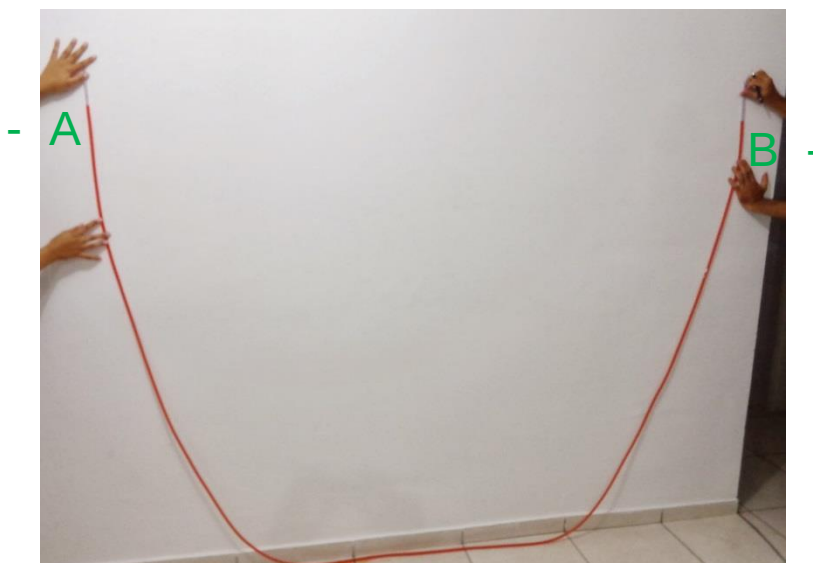
Nível do ponto A sendo transferido para o ponto B
