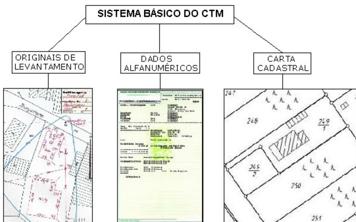
Figura 1 - Sistema básico do CTM e seus componentes. (Fonte: adaptada de Philips, 2003).
