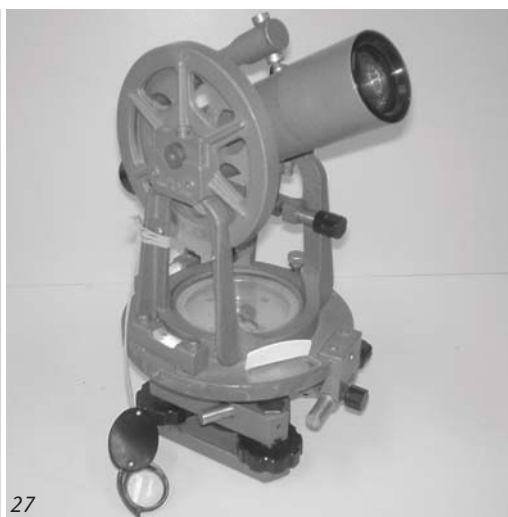
Figura 26. Teodolito Vasconcellos, modelo TV M2, fabricado no Brasil no ano de 1981, acervo do curso.
