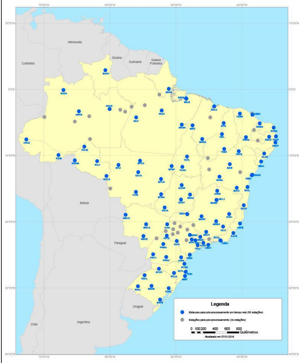
Figura 2.8 – Estações da RBMC que transferem dados em tempo real via NTRIP (serviço RBMC-IP).
