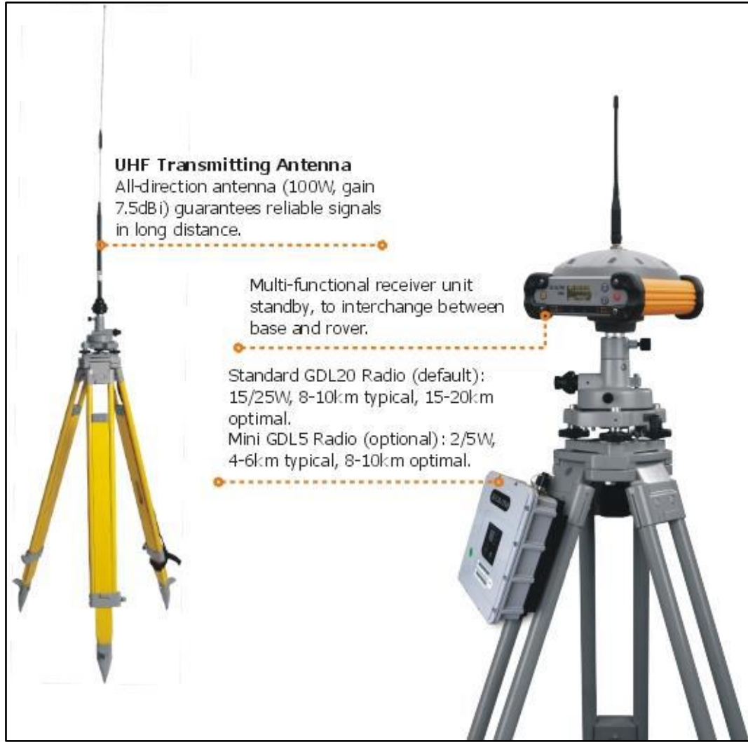
Figura 2.2 – Receptor GNSS, rádio e antena externa para transmissão das correções via UHF.
