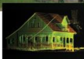
Fotografia da edificação e Nuvem de Pontos com intensidade
