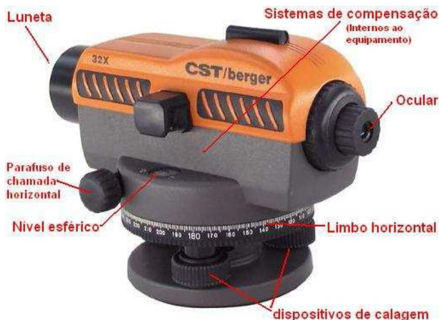
Figura 6 Indicação de funcionalidade de um Nível ótico automático (Berger, modelo CST)
