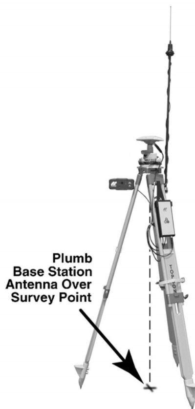
Figure 3-11. Legacy-E com Instalação de Antena PG-A1 na Estação Base
