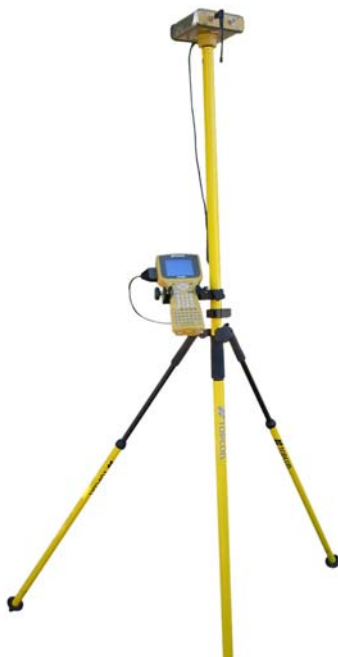
Figure 3-16. Instalação da Estação Móvel HiPer
