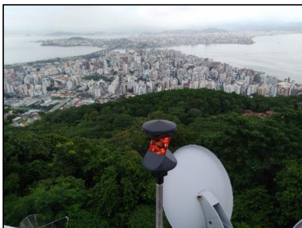
Fig. 3 – Instalação de prisma refletor 360° no ponto P1.
