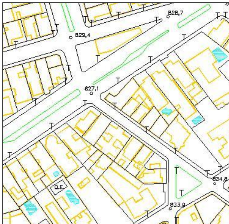
Fig. 7 - Fragmento de carta em escala cadastral, de origem fotogramétrica, com a representação das feições físicas do terreno identificada nas fotografias aéreas no momento da restituição fotogramétrica. (Fonte: Fernandes, 2009.).
