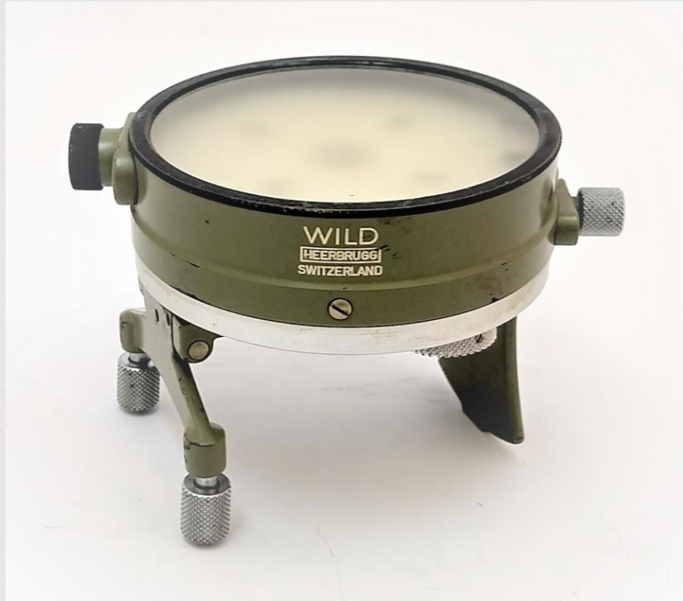
Bússola circular adaptada aos teodolitos
