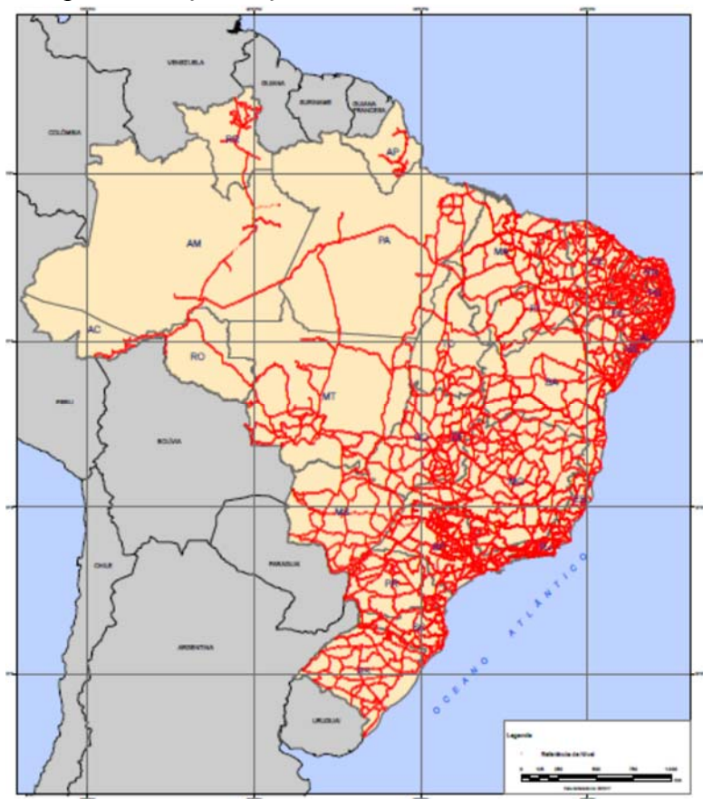
Figura 22: Rede Altimétrica do Sistema Geodésico Brasileiro
