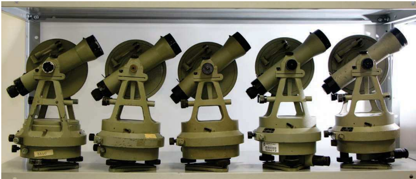
Figura 03 Teodolitos Vasconcellos modelos TVM1, TVM2, TVM3, TVM4 e TVM5, equipamentos do acervo do Museu de Instrumentos Topográficos Prof. Ênio Miguel de Souza
