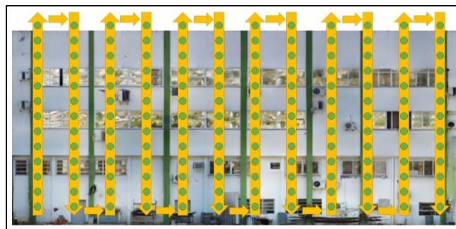
Figura 2 - Padrão de obtenção das imagens em voo vertical, as setas amarelas representam o caminho percorrido e os círculos verdes demonstram a obtenção de cada fotografia. Fonte: Os autores.
