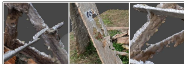
Figura 4 - Inconsistências existentes no modelo tridimensional gerado por fotogrametria. Fonte: Os autores.
